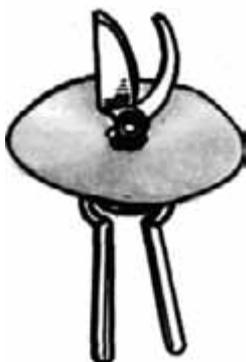
**П**ри обрезке верхних ветвей деревьев не так легко пользоваться секатором, насаженным на длинный деревянный шест: одной рукой надо держать шест, другой – верёвку, приводящую секатор в действие. Справиться с этой задачей поможет втулка, свободно перемещающаяся по шесту (Рис. 4).
